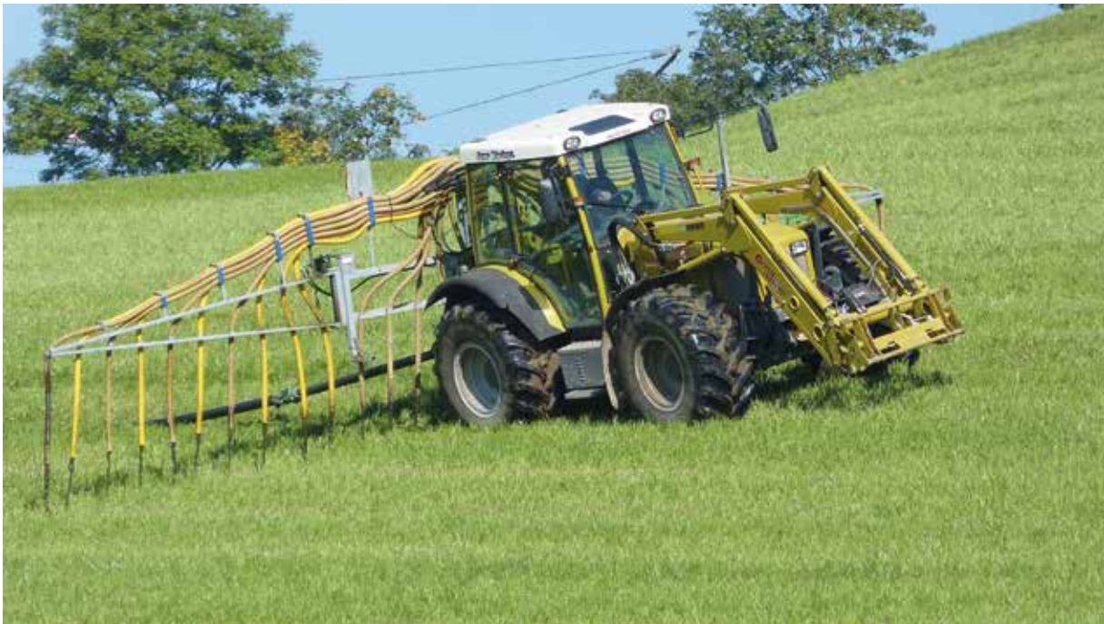
Gülleausbringung mit Schleppschläuchen
